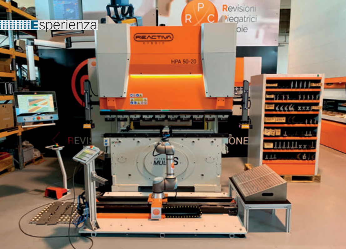
Tutte le automazioni sono assemblate su una piastra che può essere rimossa lasciando la sola piegatrice.
