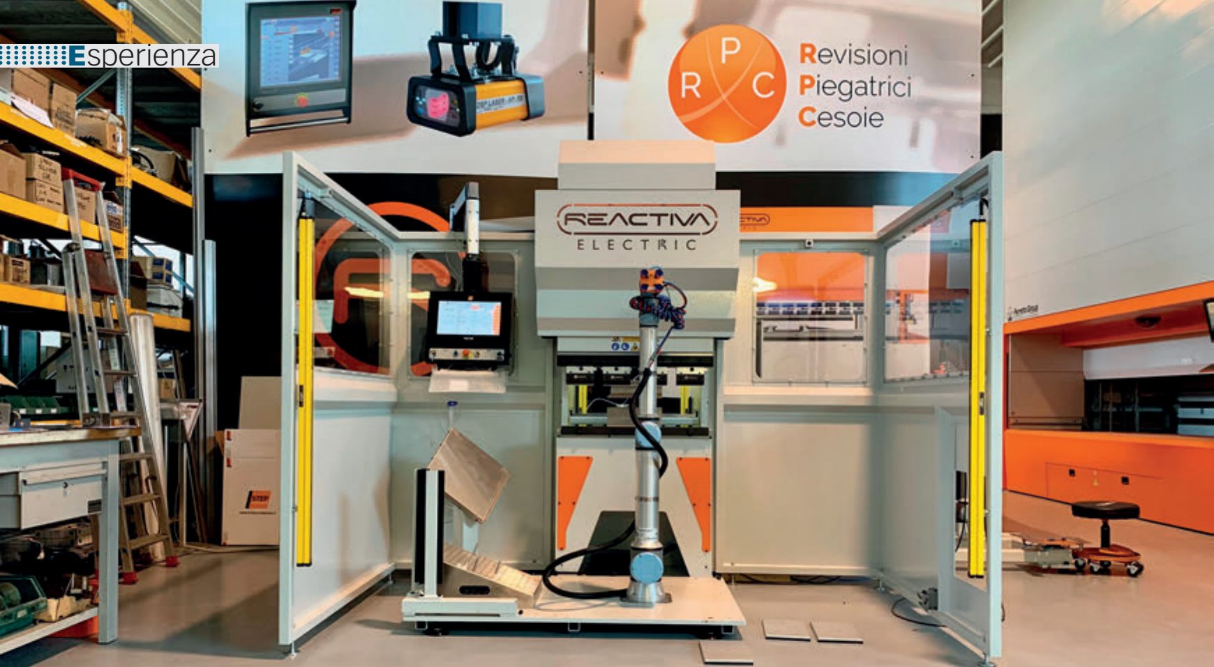
Dalla partnership tra Universal Robots e R.P.C una nuova cella robotizzata di piegatura completamente modulare.
